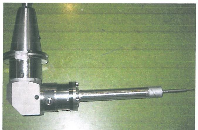
Tête de mesure montée sur renvoi d'angle
