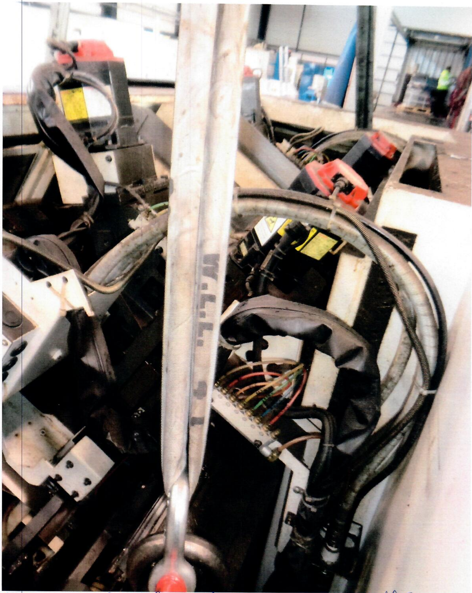
Arrière gauche élingue de 2m + tôle de 1m double 1 Ancre M36 + 1 manille GT 25
